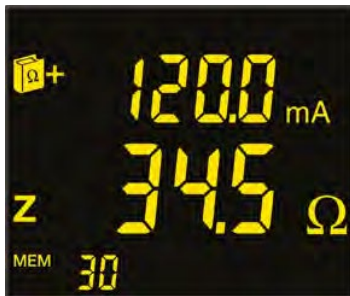
1. Anzeige: Impedanz und Fehlerstrom
