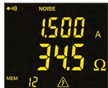
Die Funktion Berührungsspannung und deren Alarm sind sowohl beim Standard- als auch beim erweiterten Modus aktiv
