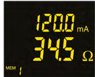
Standardmodus: Impedanz und Fehlerstrom
