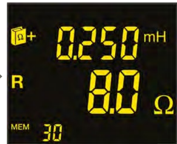
3. Anzeige: Wert des Widerstands- und Induktivitätsanteils der gemessenen Impedanz
